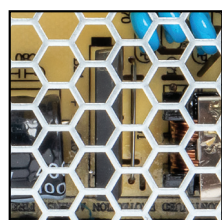
Вентиляционные отверстия для лучшего теплоотвода
